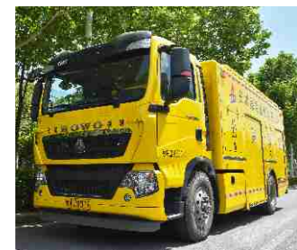
▼ 单轮式横向力系数测试车
