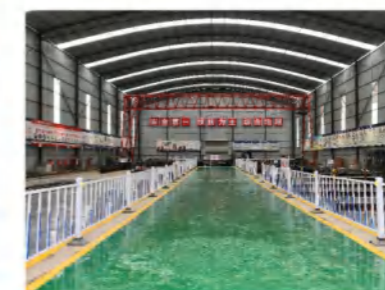
▲ 钢筋加工厂通道与作业区隔离
